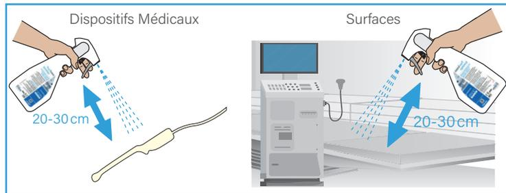
**2** Pulvériser uniformément sur la surface de manière à bien couvrir la zone à traiter ( $\pm 6 \text{ mL/m}^2$ , à 20-30 cm de la surface).
